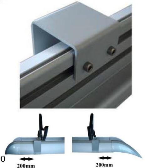
Zur vorderen unteren Befestigung der Montagewinkel an der Reling muss nun mit einem 3 mm Bohrer vorgebohrt werden. Anschließend wird der Montagewinkel mit den mitgelieferten Blechschrauben an der Reling fixiert.
